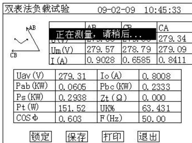
图 12 负载损耗正在测量计算页面
