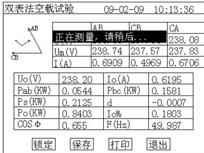
图 9 空载损耗正在测量计算页面
