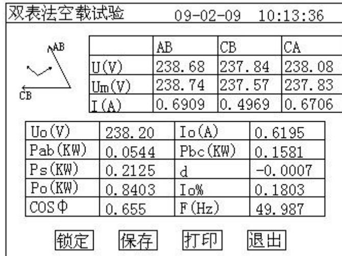
图 8 空载试验测试数据页面
